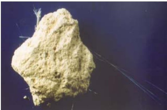
Plâtre du calorifugeage contenant quelques faisceaux de fibres d'amiante, photo: SA
