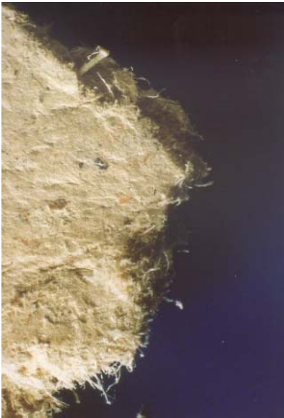
Carton d'amiante, photo: SA
